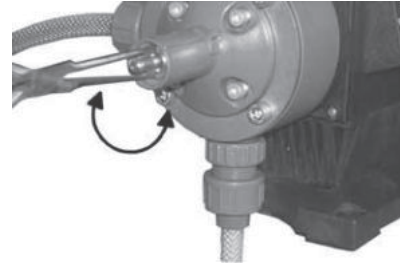
Abb. 26 Einstellung des Öffnungsdrucks
